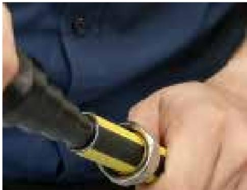
Inserte el avellanador en la tubería hasta que tope y gírelo 3 veces en la misma dirección para lograr un rectificado en la circunferencia, y al mismo tiempo, biselar el interior de la tubería para realizar un ensamble correcto con la espiga y o-rings de la conexión.
